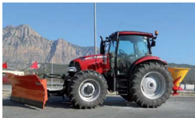
"Tractor equipado con accesorios para extender la sal potásica y apartar la nieve de la vía pública"
